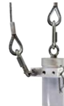
Hängende Tubes sichern mit Ringschraube + Kabel + Halter + Splint (nicht für AX1)
